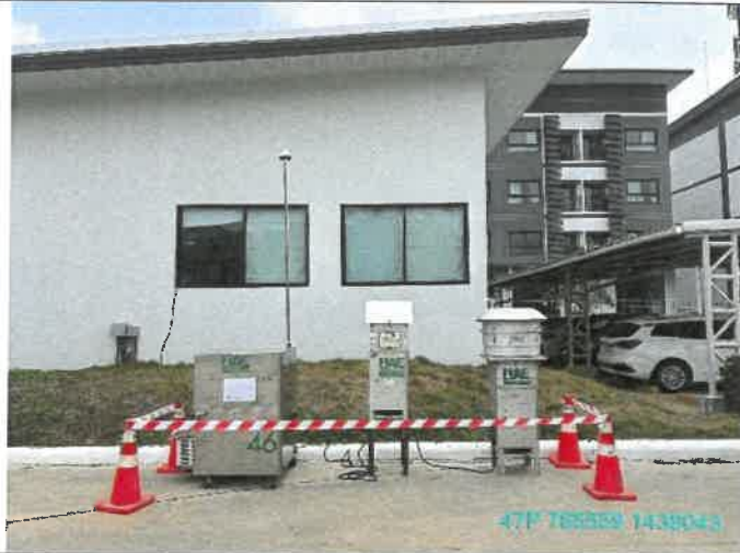
รูปที่ 3-2 การเก็บตัวอย่างคุณภาพอากาศในบรรยากาศ บริเวณภายในพื้นที่โครงการด้านทิศตะวันตกติดกับสถาบันวิทยสิริเมธี
